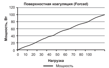
Диаграмма изменения выходной мощности по изменению номинального значения нагрузки
